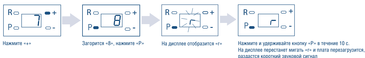
Рис. 6.3.8. Сброс параметров на заводские настройки
