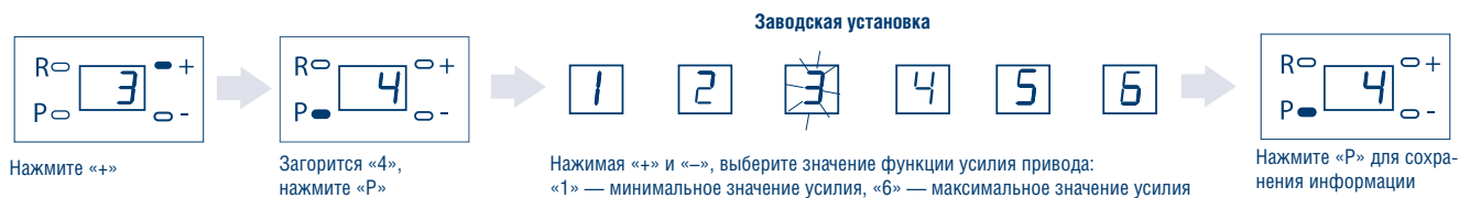
Рис. 6.3.4. Установка ограничения усилия
