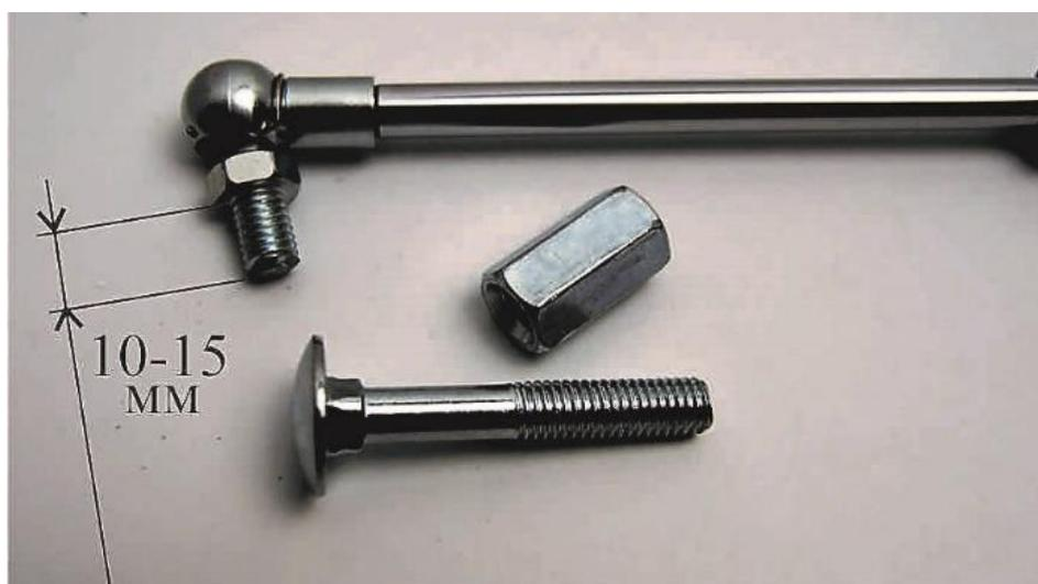
Закрепите винт М8, вверните укороченный винт шаровой опоры в удлиненную гайку наденьте пружину.
